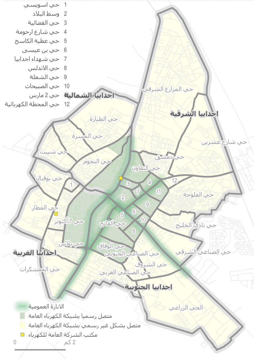
الخريطة 7: شبكة الكهرباء في وسط مدينة أجدابيا
